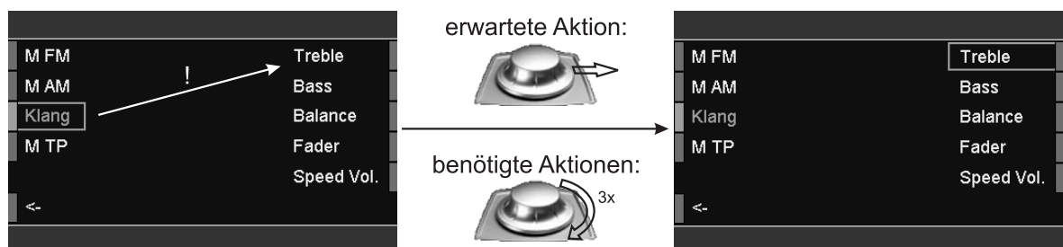
Abbildung 6.7: Verletzung einer Bedienstereotype beim Menüwechsel im BMW iDrive.
