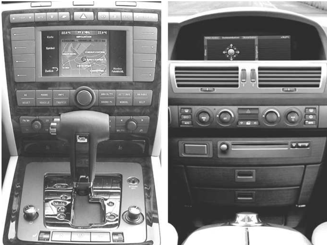
Abbildung 1.3: Fahrerinformationssysteme ohne (links – VW Phaeton) und mit (rechts – BMW iDrive) örtlicher Trennung der Anzeigefläche und Bedienelemente.
