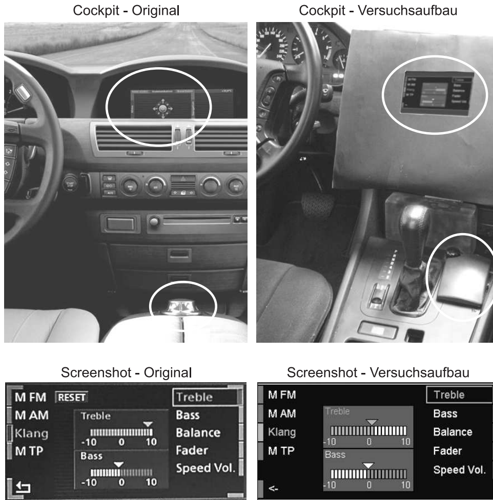
Abbildung 6.3: Das FIS BMW iDrive im Original (links) und im Versuchsaufbau (rechts). Ein Beispiel der Darstellung von Informationen auf dem zentralen Display ist ebenfalls abgebildet.
